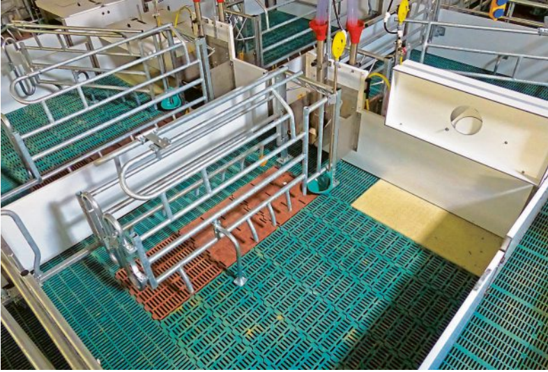
Die Bewegungs-Abferkelbucht mit abgedecktem Ferkelnest bietet viel Platz. Der Ferkelschutzkorb wird aufgeklappt, sodass die Sau sich frei bewegen kann.
