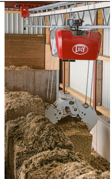
Der Misch- und Fütterungsroboter stellt eigenständig Rationen zusammen und füttert sie aus.
