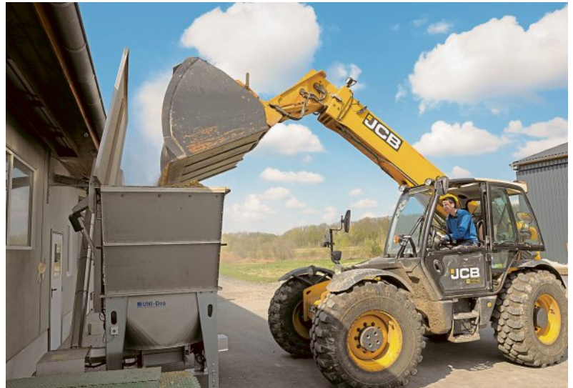
Die Anlage wird einmal täglich mit dem Teleskoplader befüllt.
